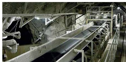
長距離ベルトコンベア(全長4km)
